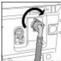
Заливной шланг подсоединяется наверху, справа
